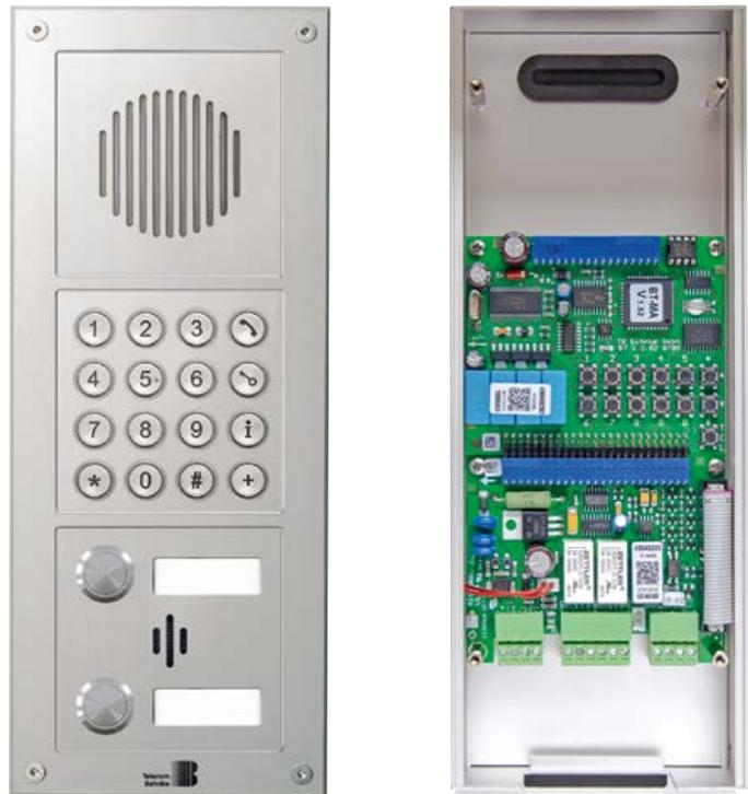
Abbildung 1: Frontansicht eines Kompaktgerätes und Sicht auf die Elektronik
