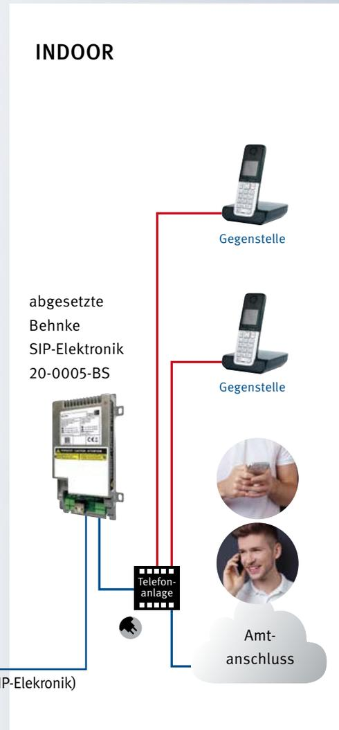
Schema SIP: entfernt abgesetzte Montage an Multi-Taste (bis 100 Tasten)
