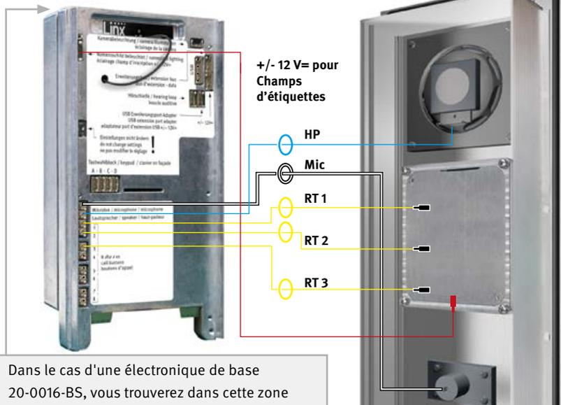
Dans le cas d'une électronique de base 20-0016-BS, vous trouverez dans cette zone une équerre de fixation pour le montage sur des points de fixation fournis par le client. Vous trouverez les cotes sous :
