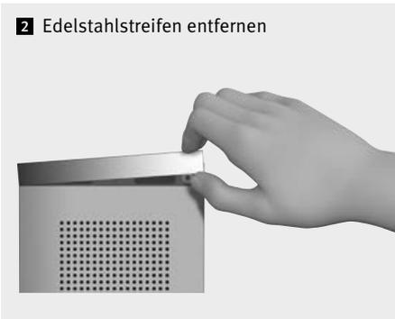
Türstationen der Serie 50 werden bereits montiert geliefert. Gehen Sie bitte beim Einbau wie hier gezeigt vor. Hinweise zur elektrischen Montage finden Sie auf den folgenden Seiten.
