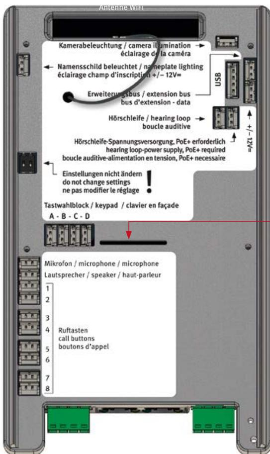
Pour les modèles 20-0003-BS, 20-0015-BS, 20-0017-BS, c'est ici que se trouve le câble de raccordement pour l'écran tactile Behnke.
