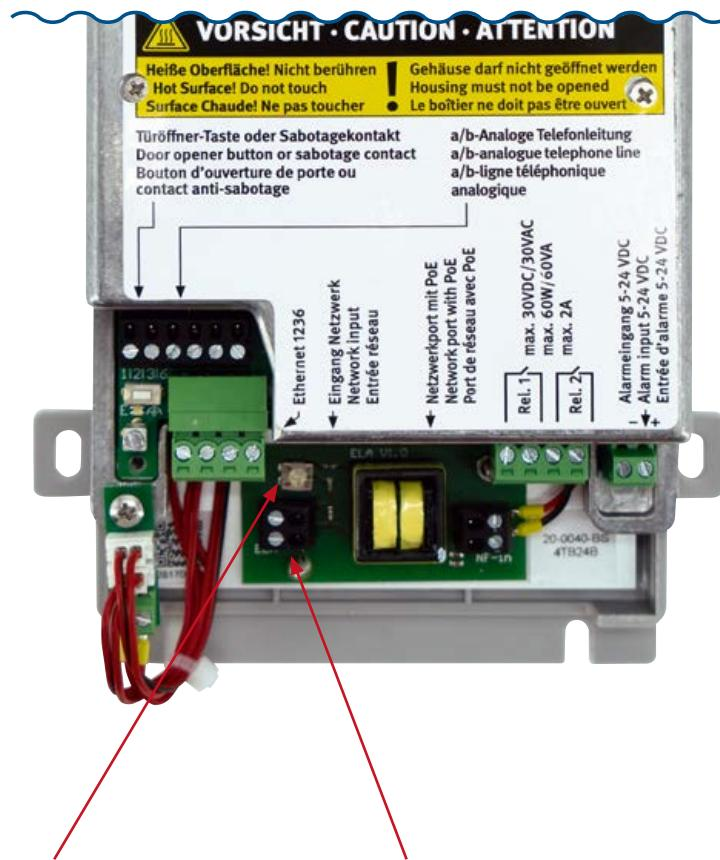
Pegelsteller zum Einregeln des Ausgangssignals. Auslieferungszustand: ~200 mV
