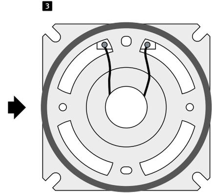
Lautsprecher mit Schutzgitter und Dichtung montieren.
