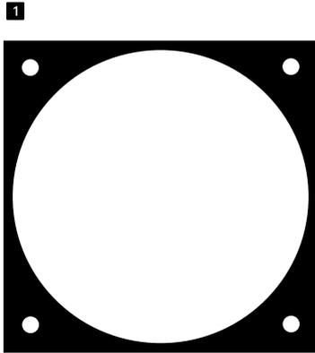
Schutzfolie der Klebfläche abziehen und die Dichtung auf das Schutzgitter kleben.
