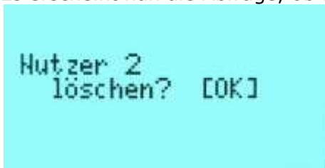
Mit Druck der Taste  $\text{OK}$  werden alle Finger und der Benutzername gelöscht, mit Druck der Taste  $\text{ESC}$  können Sie den Löschvorgang hier noch abbrechen.
