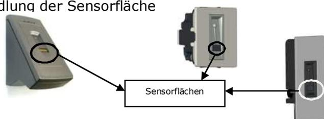
Die Sensorfläche des Fingerscanners ist das wesentliche Element ihres ekey home-Systems und bedarf einer entsprechenden Behandlung, um zuverlässig und dauerhaft zu funktionieren.
