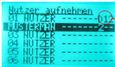
Die Nummern zeigen, dass diese Finger für den entsprechenden Benutzer bereits belegt sind und auf welches Relais dieser Finger wirkt:
